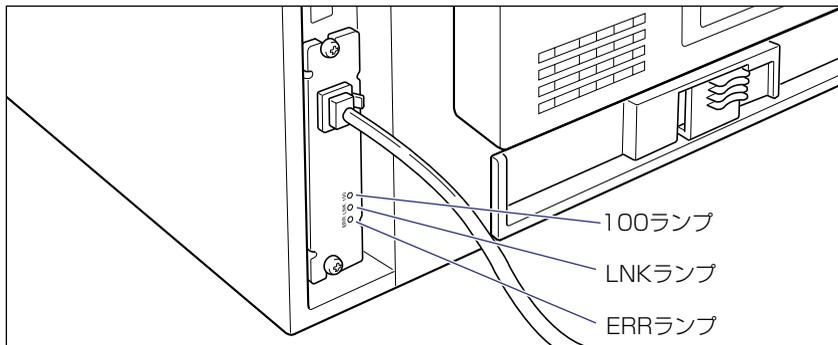
正常に動作していない場合はプリンタの電源をオフにし、LANケーブルの接続やハブの動作、プリントサーバの取り付け状態を確認してください。(→プリントサーバに付属の取扱説明書)
