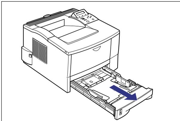
**2** 後側の用紙ガイドのロック解除レバーを押しながら ①、セットする用紙サイズの位置に合わせて用紙ガイドを移動します ②。
