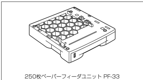
**警告** ● ペーパーフィーダを取り付けるときは、必ずプリンタの電源をオフにし、電源プラグを抜き、プリンタ本体に接続されているすべてのインタフェースケーブルや電源コード、アース線を取り外してください。そのまま作業を行うと、電源コードやインタフェースケーブルが傷つき、火災や感電の原因になります。
