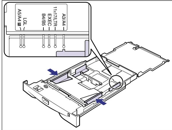
500 枚給紙カセットの場合、側面の用紙ガイドのロック解除レバーをつまみながらセットする用紙サイズの位置に合わせて用紙ガイドを移動します。
