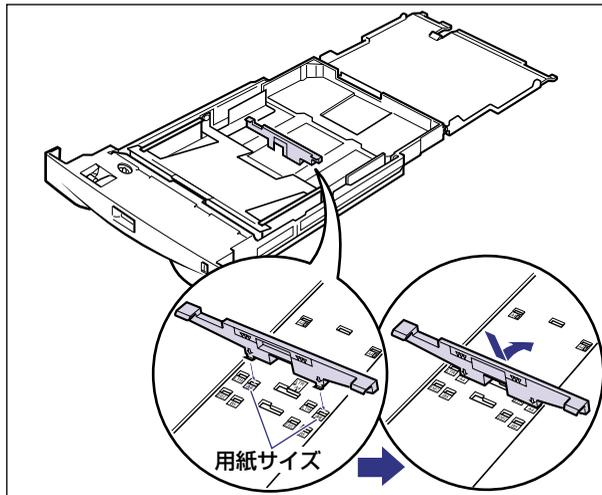
500 枚給紙カセットの場合は、後側の用紙ガイドのロック解除レバーをつまみながらセットする用紙サイズの位置に合わせて用紙ガイドを移動します。
