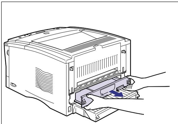
**警告** 製品内部には、高圧になる部分があります。メインボードを取り外したり取り付けたりするときは、ネックレス、プレスレットなどの金属物が製品内部に触れないように注意してください。感電の原因になります。
