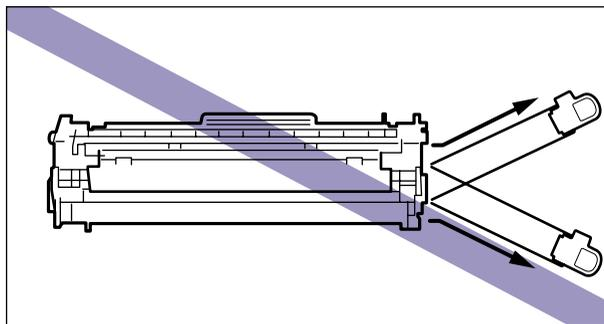
●シーリングテープは最後まで完全に引き抜いてください。シーリングテープがカートリッジ内に残っていると、印字不良の原因になります。
