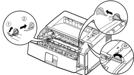
左側にある梱包材は、テープを取り外してから①、梱包材を矢印の方向に取り外します②。
