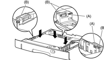
**8** 用紙サイズ設定スイッチの取っ手を持って、用紙サイズ設定スイッチをセットした用紙のサイズに合わせます。
