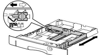
**4** 側面の用紙ガイドのロック解除レバーをつまみながら、セットする用紙サイズの位置に合わせて用紙ガイドを移動します。
