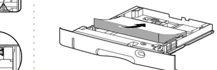
**7** 用紙を図のように下へ押さえ、積載制限マーク (A) を超えていないか確認し、用紙ガイドに付いているツメ (B) の下に用紙を入れます。
