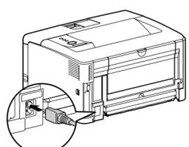
**2** アース線のキャップを外してアース線を専用のアース線端子へ、電源プラグを電源コンセントへ接続します。
