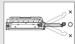
シーリングテープを引き抜くときは、トナーカートリッジメモリ (A) に触れたり、ドラム保護シャッター (B) を手で押さえないように気を付けて作業を行ってください。
