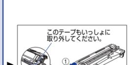
テープを①、②の順に取り外します。②で取り外すテープは、テープの後端にもう1枚のテープが貼り付いていますので、いっしょに取り外します。
