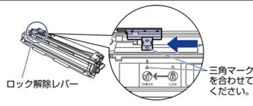
2 左右のドラムカートリッジガイド付近にあるレバーが、図のように正しい位置にあるか確認する。
