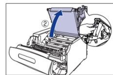
4 交換する色のドラムカートリッジの青色のロック解除レバーを「④」の位置までスライドさせて、ロックを解除する。
