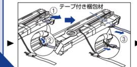
テープ付き梱包材は、テープを取り外し①、梱包材も同時に取り外します。梱包材が取り外せない場合は、倒してから②、取り外します③。
