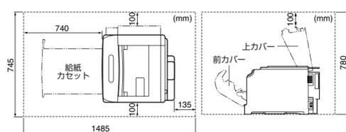
必ず、図に示すスペースを確保してください。プリンタ本体は約52kgあり、トナーカートリッジとドラムカートリッジを取り付けると約60.9kgになります。オプションのペーパーフィーダを3台取り付けると約93.9kgになります。必ず、本プリンタやオプション品の質量に耐えられる十分な強度のある場所に設置してください。ぐらついた台の上や傾いた所などの不安定な場所、振動の多い場所、パソコンラックの上段などに設置しないでください。落ちたり倒れたりして、けがの原因になることがあります。本プリンタを設置する前に、詳しい設置環境について、本プリンタに付属の「取扱説明書CD-ROM」に収められている設置ガイドを必ずお読みください。
