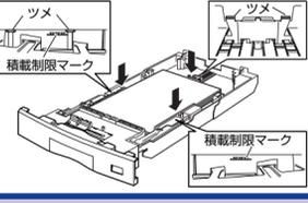
**7** 用紙サイズ表示板に、セットした用紙サイズのシールを貼り、給紙カセット前面の用紙サイズ表示板差し込み口に差し込みます。
