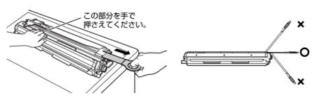
**14** ドラムカートリッジをセットする前に、図のように水色のつまみの三角マークとラベルの「解除」の三角マークの位置を同じ位置に合わせてください。
