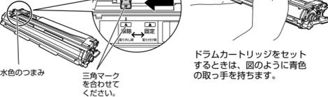
**15** 左右のドラムカートリッジガイド付近にあるレバーが、図のように正しい位置にあるか確認します。
