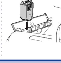
**29** ロック解除レバーを「O」の位置まで倒して、トナーカートリッジをロックします。
