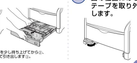
10 給紙カセット内部の梱包材を取り外します。
