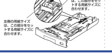
**4** 側面の用紙ガイドのロック解除レバーをつまみながら、セットする用紙サイズに合わせます。
