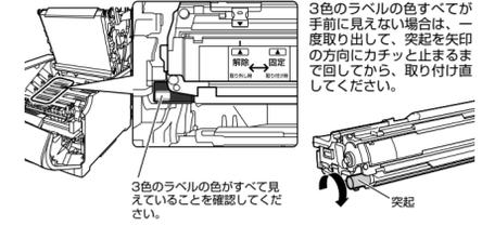
**19** 取り付けた色のドラムカートリッジの水色のつまみを「固定」の位置までスライドさせて、ドラムカートリッジを固定します。
