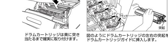
**17** 左右のドラムカートリッジガイド付近にあるレバーが、図のように正しい位置にあるか確認します。
