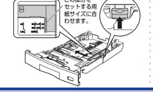
**5** 用紙の後端を、用紙ガイドに合わせてセットします。
