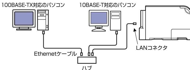
**注意** プリンタにネットワークケーブルを接続するときは、必ずプリンタの電源をオフにし、電源コンセントから電源プラグを抜いてから行ってください。感電の原因となることがあります。
