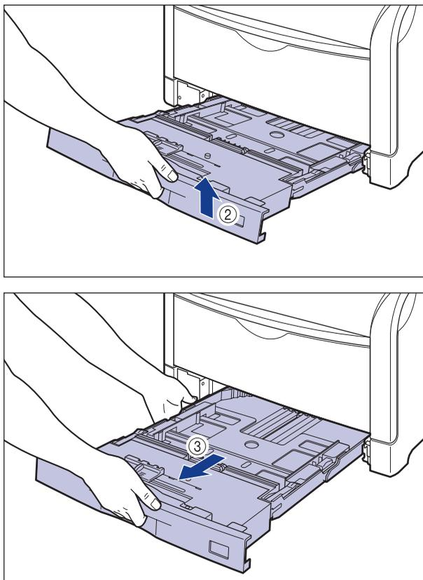
**⚠ 注意** 用紙をセットするときは、必ず給紙カセットをプリンタから取り出してセットしてください。給紙カセットを途中まで引き出した状態で用紙をセットすると、給紙カセットが落ちたりプリンタが倒れたりして、けがの原因になることがあります。
