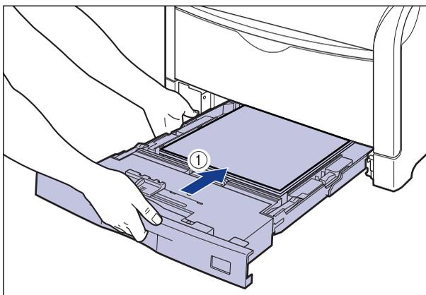
給紙カセットの手前を少し持ち上げてから ②、給紙カセットの前面が、プリンタの前面と揃うまで、しっかりと奥まで押し込みます ③。
