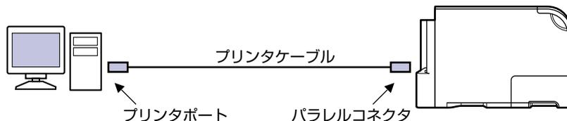
なお、本プリンタを PC-9800 シリーズや PS/55、HP7550B などのパソコンに接続して使用する場合、オプションのコントロール ROM（CR-HIT）が必要です。また、これらのパソコンからプリントする場合、インタフェースの自動切り替えや動作モードの自動切り替えができないことがあります。このようなときは、使用しているインタフェースおよびコントロールROMのエミュレーションモードに固定してご使用ください。コントロールROMには、次のエミュレーションモードとフォントが収録されています。
