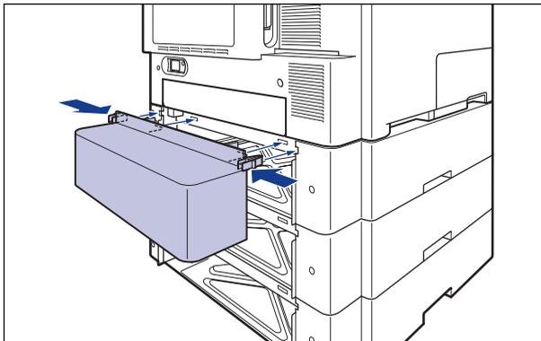
**重要** カセット保護カバーに手をかけたり、強く押ししたり、物を置いたりしないでください。カセット保護カバーが破損する恐れがあります。
