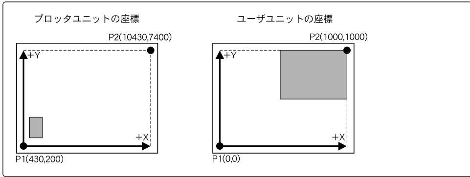
1ユーザユニットが1プロッタユニットより小さくなるような設定を行うと、1プロッタユニットと同じに設定されます。
