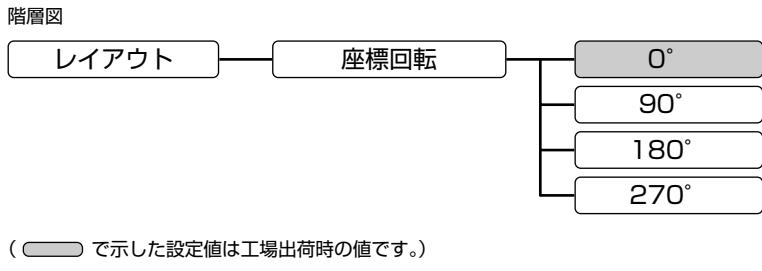
印刷時の座標系の回転を設定します。
