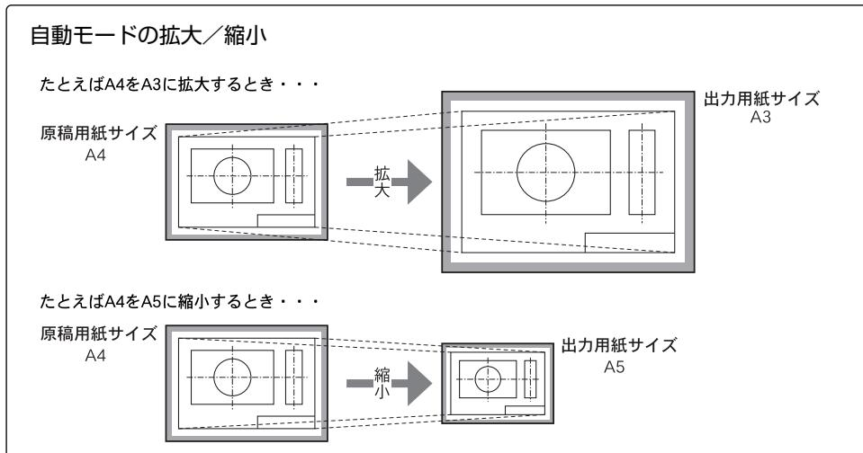
自動モードでの拡大／縮小率は、クリップモードによって異なり、それぞれ作図データを次のように拡大／縮小します。
