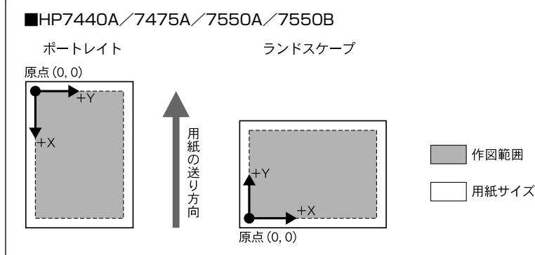
原点が中央の機種では、印字方向によって座標が次の向きになります。
