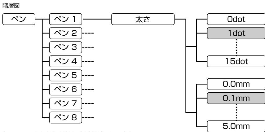
グラフィックス・プロッタの8種類のペンに対応する線の太さを設定します。
