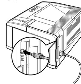
3 USBケーブルのAタイプ(平たい)側をコンピュータのUSBポートへ接続し、コンピュータの電源を入れ、Windowsを起動します。
