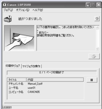
プリンタ使用中は定着器周辺が高温になっています。紙づまりの処理をするときは、定着器が完全に冷えてから作業を行ってください。定着器が高温のまま触れると、やけどの原因になります。
