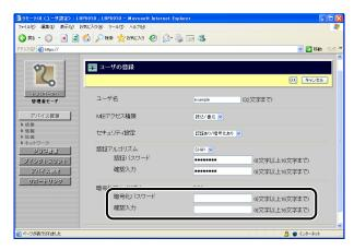
① 重要 SSL 暗号化通信機能を使用していない場合は、リモート UI では設定できません。暗号化 パスワードを設定するときは、プリンタの操作パネルで行います(→ネットワークガイ ド「第2章ネットワークの共通設定」)。
