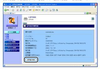
検証結果が表示されますので、「証明書詳細情報へ戻る」をクリックします。
