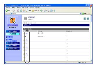
3 保存ジョブを操作したいときは、ジョブの先頭にある をクリックして たけけてから、操作ボタンをクリックします。
