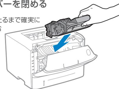
上記の操作をしても印刷結果が改善されないときは、新しいトナーカートリッジに交換してください。☞ P.9
