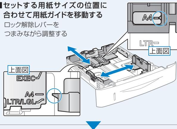
■ 印刷面を下にして、用紙を後端の用紙ガイドに合わせてセットする
