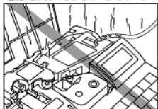
チューブをセットしたままの状態で電源を入れっぱなしにしないでください。チューブが過熱しすぎて火災の原因になります。
