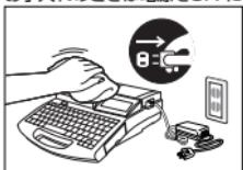
清掃するときは電源スイッチをOFFにし、ACアダプタのプラグを電源コンセントから抜いてください。
