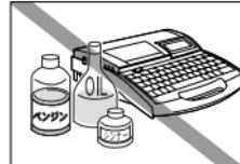
アルコールやシンナーなど引火性溶剤の近くで使用しないでください。溶剤が内部に入ると火災の原因になります。また、本機を拭くときは、水にしめさせて固くしぼったガーゼを使用し、アルコール、ベンジン、シンナーなどの引火性溶剤は使用しないでください。溶剤が内部の電気部品に触れて火災や感電の原因となります。
