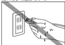
手が濡れた状態でACアダプタのプラグなどを抜き差ししないでください。感電の原因になります。
