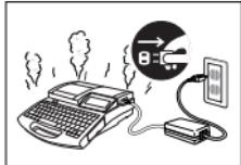
発煙、異臭のときはすぐに本体の電源スイッチをOFFにし、電源コンセントからACアダプタのプラグを抜き、お近くの販売店にご連絡ください。そのまま使用すると、火災や感電の原因になります。
