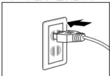
ACアダプタのプラグは確実に電源コンセントに差し込んでください。火災や感電の原因になります。
