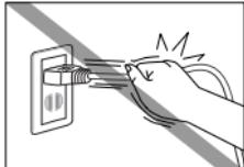
電源プラグをコンセントから抜くときは、コードではなくプラグ部を持ってまっすぐに抜いてください。コードが傷つくと火災や感電の原因になることがあります。また、ACアダプタを抜き差しするときは、必ず本機の電源スイッチがOFFになっていることを確認してください。
