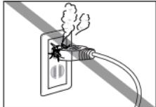
ACアダプタのプラグは定期的に清掃してください。ホコリや汚れ、油煙などが付着した状態で長時間使用すると、ホコリが湿気を吸って絶縁不良となり、火災の原因になります。
