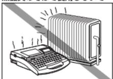
熱器具のそばで本機を使わないでください。コードなどが溶け火災や感電の原因となります。
