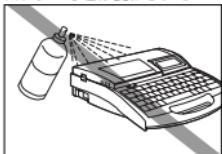
本機のそばで可燃性のスプレーなどを使用しないでください。スプレーのガスが内部部品に触れて、火災や感電の原因になります。
