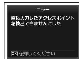
OK ボタンをタッチして入力したアクセスポイント名/ネットワーク名 (SSID) が正しいことを確認し、もう一度 OK ボタンをタッチしてください。
