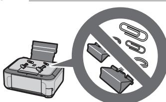
原稿台カバー上には物を置かないでください。原稿台カバーを開けたときに後トレイに物が落ち、故障の原因になります。また、上から物が落ちる場所などには、本製品を置かないでください。
