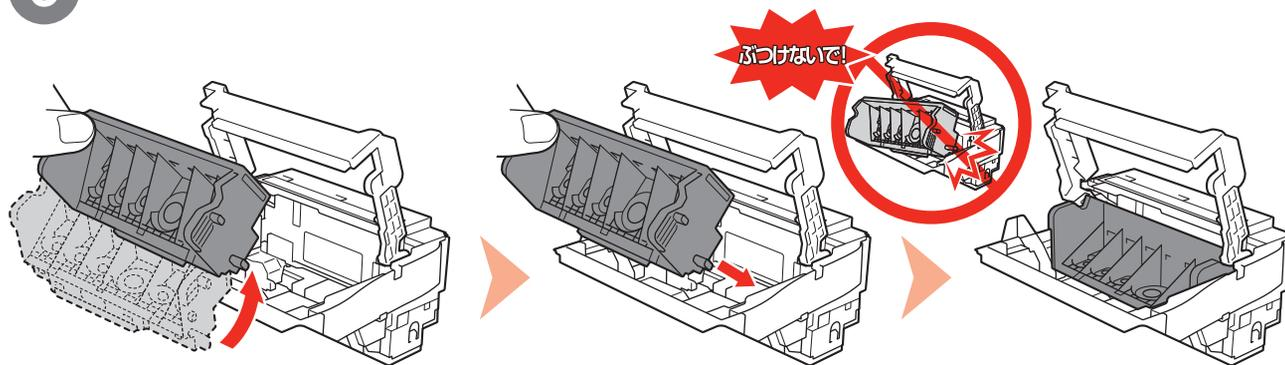
プリントヘッドを図のように手前側に傾けてセットする
