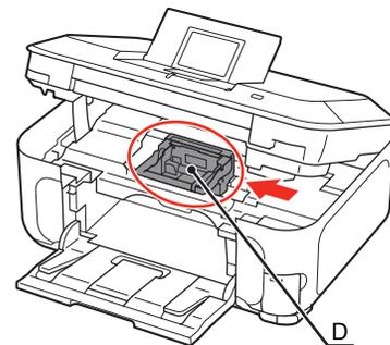
プリントヘッドホルダー (D) が取り付け位置に移動したことを確認する
