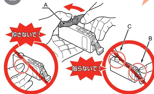
インクタンクの底部にあるオレンジ色の保護キャップ (A) を、左手の親指で上から押さえながらひねって取り外す
