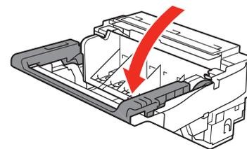
プリントヘッド固定レバーを完全に下げる
