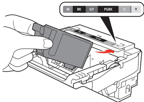
インクタンクを傾け、ラベルの下側にくぐらせて奥に差し込む
