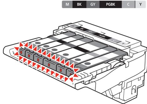
残りのインクタンクを、同じ手順で取り付けるすべてのインクタンクを取り付けてください。すべてのイン克蘭プ（赤色）の点灯を確認してください。
