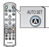
画面サイズ調整後のピント合わせとキーストーン補正（台形ひずみの自動補正）をします。
