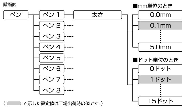
グラフィックス・プロッタの8種類のペンに対応する線の太さを設定します。
