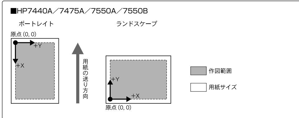
原点が中央の機種では、印字方向によって座標が次の向きになります。
