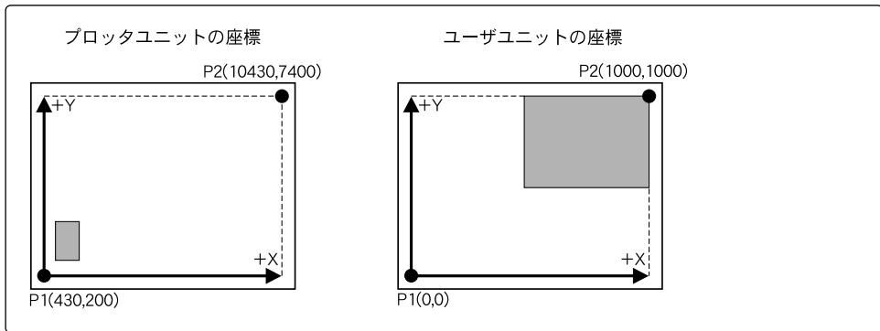
1ユーザユニットが1プロッタユニットより小さくなるような設定を行うと、1プロッタユニットと同じに設定されます。
