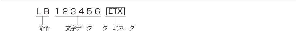
このほか、HP-GL命令には本プリンタからホストコンピュータに対して座標位置や状態などを出力する命令があります。出力命令に対して本プリンタが outputするデータの最後にもターミネータが付加されており、これは[CR]コード（[CR]（TERM）と表記します）となっています。このターミネータは出力モード設定命令[ESC].Mによって、ほかの文字キャラクタに変更することが可能です。
