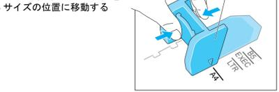
3. 用紙をさばいて揃え、印刷面 (D) を下向きにしてカセットにセットする
