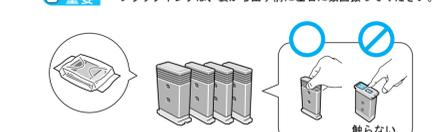
4. 全てのインクタンクカバーをカチッと音で押し、閉じる
