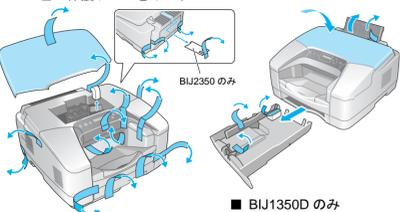
3. BIJ1350D の場合は、自動両面印刷ユニット (a) をカチッと音がするまで押し込みます。
