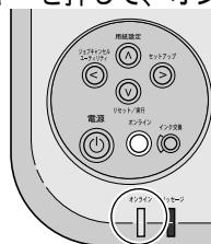
ディスプレイに「インサツ カノウ」が表示され、印刷できる状態になります。コンピュータで印刷を行ってください。
