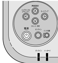
オンラインランプやメッセージランプが点滅したあと、準備が終わるとオンラインランプが点灯してディスプレイに「インサツ カノウ」が表示され、印刷できる状態になります。
