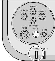
ディスプレイに「インサツ カノウ」が表示され、印刷できる状態になります。
