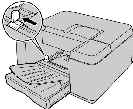
**5** 印刷面 (b) を下向きにし、用紙をトレイの右側ガイド (a) 及びカセットの奥に突き当ててセットします。
