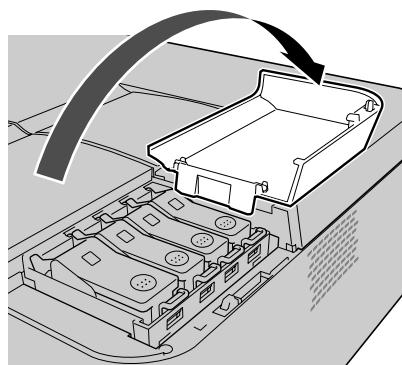
**3** インクタンクレバーを押し上げて、インクタンクカバーを開きます。
