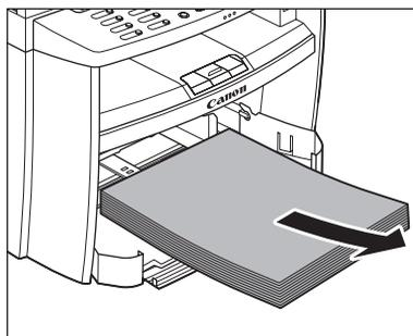
**12** 用紙カセットの前面部を持ち上げ、手前に引いて取り外します。
