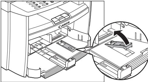
**7** はがき用ガイドを用紙後端ガイドに差し込み、前方に倒します。
