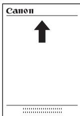
封筒をセットする場合は、プリントしたい面を上にして右端から先に封筒をまっすぐに手差しトレイに差し込みます。
