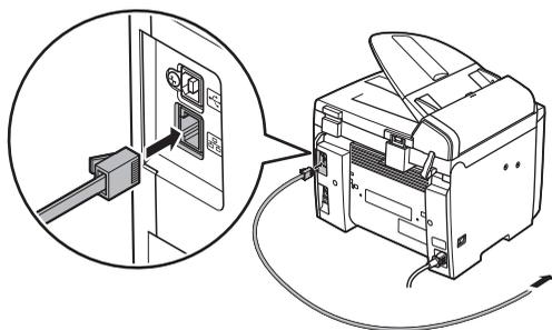
TCP/IP ネットワークで使用できるよう本製品を設定し、ネットワークルータまたはハブに本製品とコンピュータを接続します。
