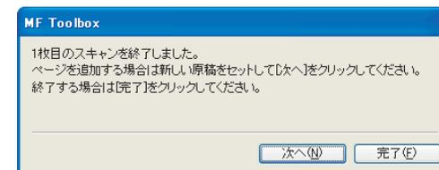
スキャンを続ける場合は、次のページをセットして [次へ] をクリックします。読み込みが終了したら、[完了] をクリックします。
