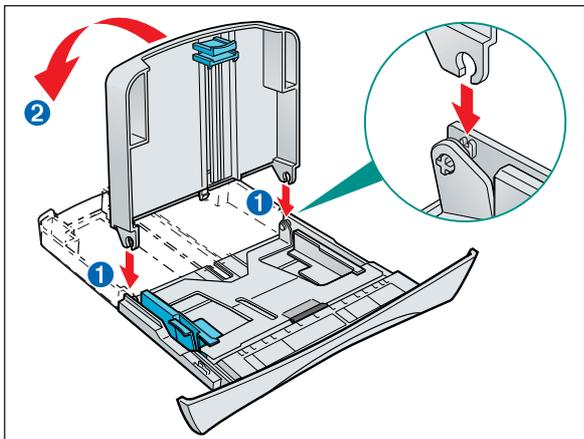
3 延長カセットをカセットに取り付けます。差し込み口①の軸に直角に差し込んでください。接合部分がかみ合ったら、延長カセットを図のように倒します②。
