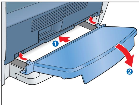
**9** 延長カバーのツメを本体後部の差し込み口①に差し込み、延長カバーがその真下の延長カセットに接触するまでゆっくりと下方に倒します②。
