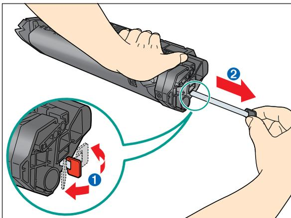
3 カートリッジを平らで安定した台などに置き、片手でカートリッジを押さえながら、もう一方の手でタブ①を折り曲げ、テープ②を完全に引き抜きます。
