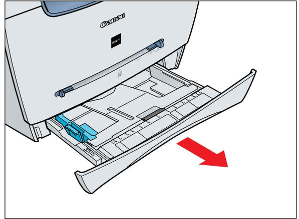
2 本体からカセットを完全に抜き出します。
