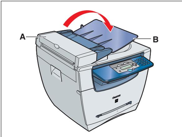
1 ADF (A) を軽く押さえて、原稿給紙トレイ (B) を矢印の方向に開きます。
