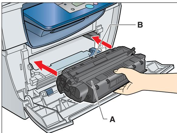
5 カートリッジ両側の突起を本体内部のガイドに合わせ、説明ラベル(A)および矢印(B)が上を向くようにカートリッジを持ち、カートリッジが完全に収まるまで水平に押し込みます。
