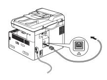
TCP/IP ネットワークで使用できるよう本 製品を設定し、ネットワークルータまたは ハブに本製品とコンピュータを接続しま す。
