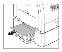
カセットを引き出し、用紙の角をツメ の下に押し込みます。
