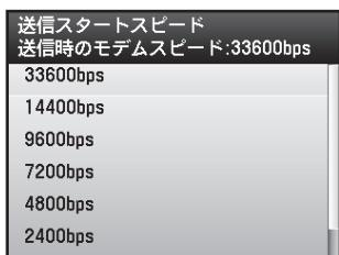
送信が始まるまでに時間がかかるときは、回線状態が悪い可能性があります。<33600bps>から<14400bps>、<9600bps>、<7200bps>、<4800bps>、<2400bps>の順にスピードを下げて、調整してください。
