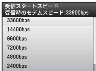
受信が始まるまでに時間がかかるときは、回線状態が悪い可能性があります。<33600bps>から<14400bps>、<9600bps>、<7200bps>、<4800bps>、<2400bps>の順にスピードを下げる、調整してください。
