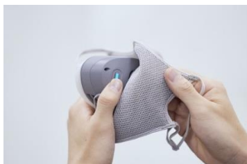
ボタンを3秒長押しで電源 ON
